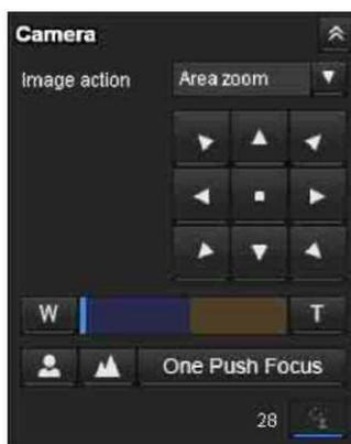
На этой панели вы можете управлять функциями панорамирования/наклона/возврата в исходное положение камеры, регулировать масштаб изображения и переключать режим фокусировки. В дополнение к этому, вы можете получить разрешение на управление камерой, когда включен режим исключительного управления.
