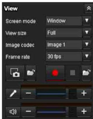
Вы можете изменить режим экрана, размер изображения, режим кодека изображения и частоту кадров. Также, используя эту панель, можно сохранять неподвижные и видеоизображения (возможна остановка процесса сохранения видеоизображения). Имеется возможность настройки микрофона и уровней на выходах звука.
