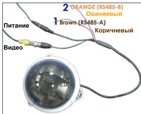
Рисунок 5: Пример проводов RS485-A и RS485-B
